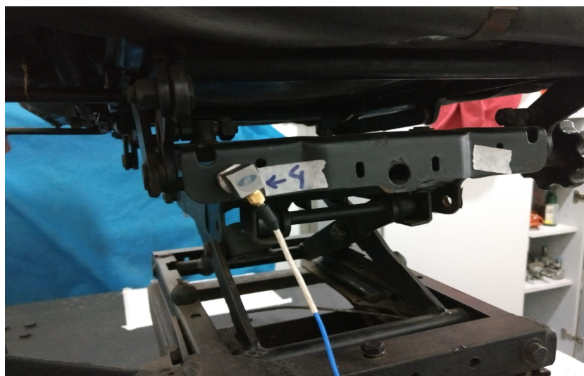
Figura 5.7 – Acelerômetro ICP fixado no ponto "4" para aferir amplitude de vibração no local
