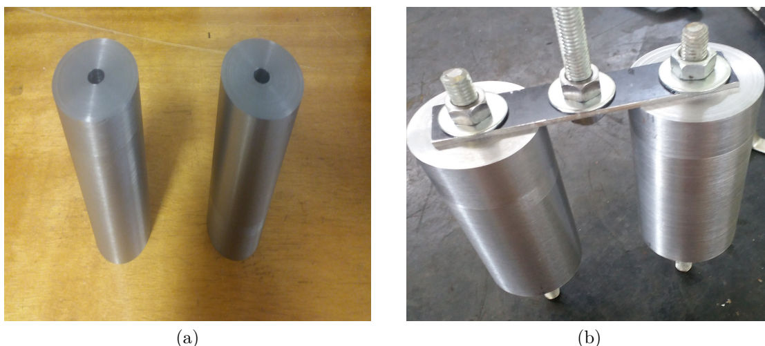
Figura 4.6 – (a) Blocos de massa de aço SAE 1020 finalizados. (b) Montagem final dos blocos de massa fixados por meio de hastes e uma chapa de aço
