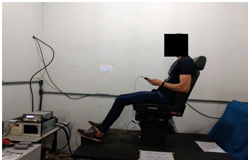
Figura 5.12 – Medição de vibração de corpo inteiro com ocupante para análise da interferência da inclusão de massa no funcionamento do ADV
