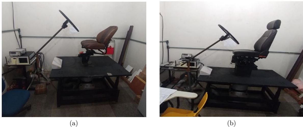
Figura 1.3 – Bancadas de testes para assentos (a) urbano e (b) rodoviário (Fonte: Moore (2017))
