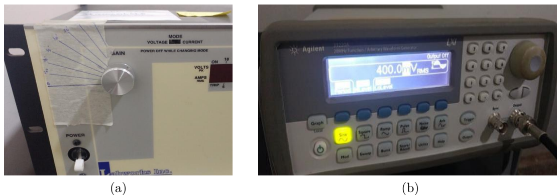
Figura 5.4 – Configuração dos equipamentos de excitação: (a) Escala criada no amplificador para identificação do ganho aplicado ao sistema; (b) Amplitude do sinal determinado no gerador de sinais
