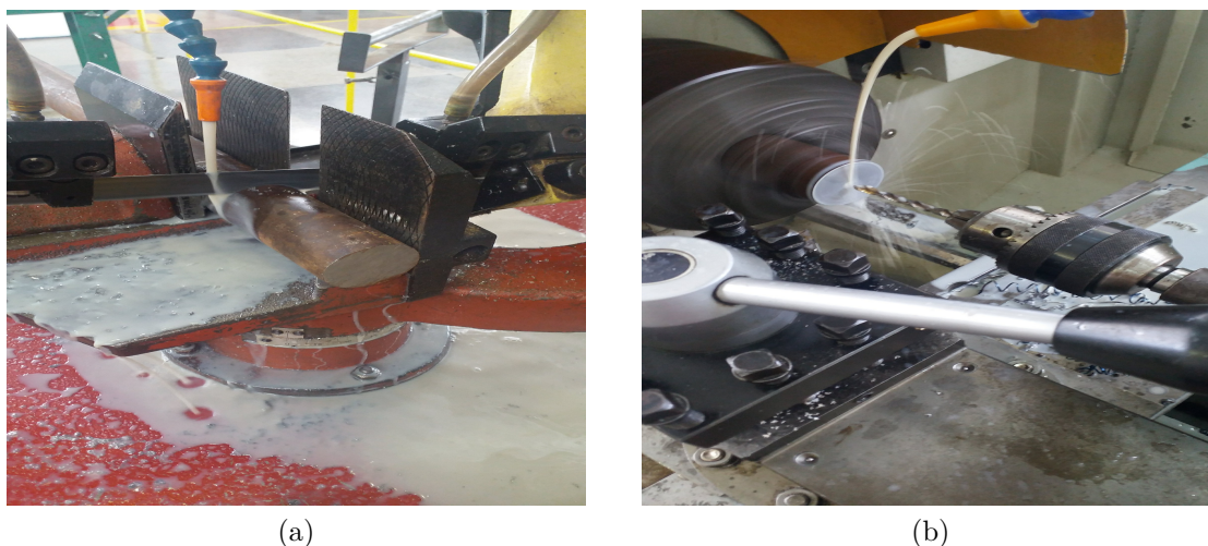
Figura 4.5 – Processo de fabricação do bloco de massa cilíndrico. (a) Corte do tarugo utilizando a máquina serra fita. (b) Furação do cilindro no torno mecânico
