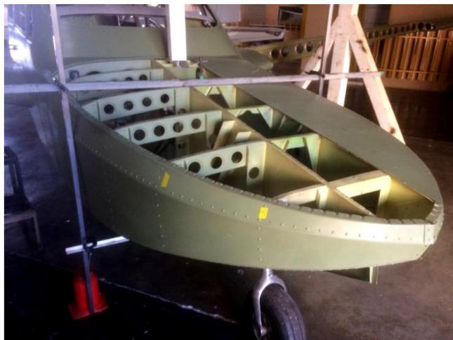
Figura 18 – Barras posicionadas para o desenho da seção transversal da 4ª estação
