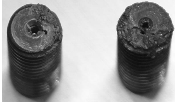
Figura 52 - Injetores de combustível erodido (após 350 e 615 segundos, respectivamente).
