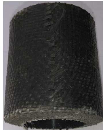
Amostra de compósito de silicone preto (SI-P) com a superfície da fita de fibra de vidro paralela ao eixo do motor
