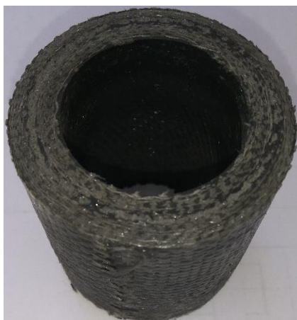
Amostra de compósito de silicone preto (SI-P) com a superfície da fita de fibra de vidro paralela ao eixo do motor
