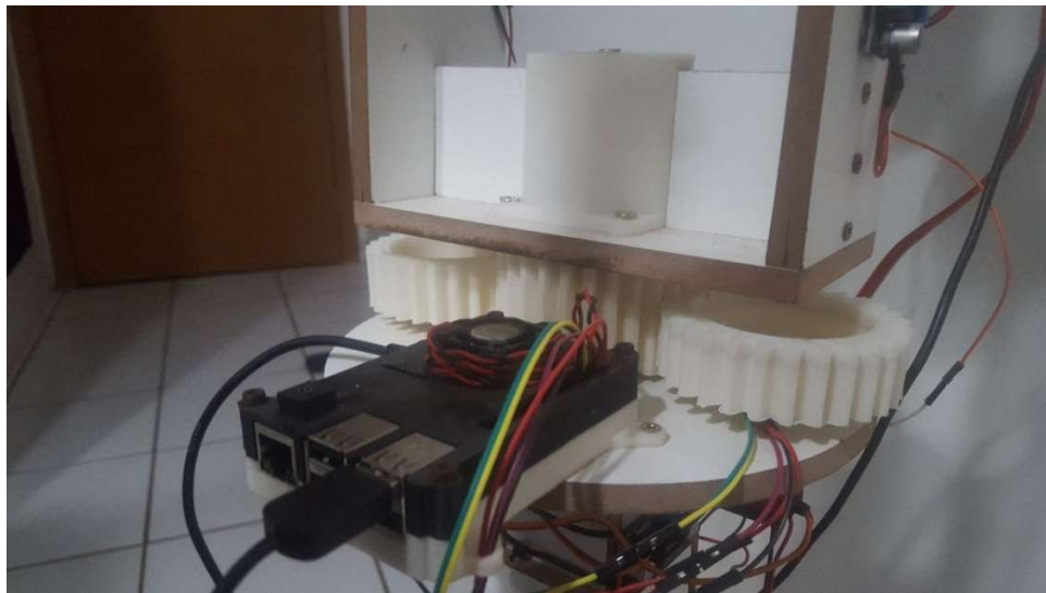
Figura 72: Conexões no Raspberry Pi e engrenagens de movimentação horizontal.
