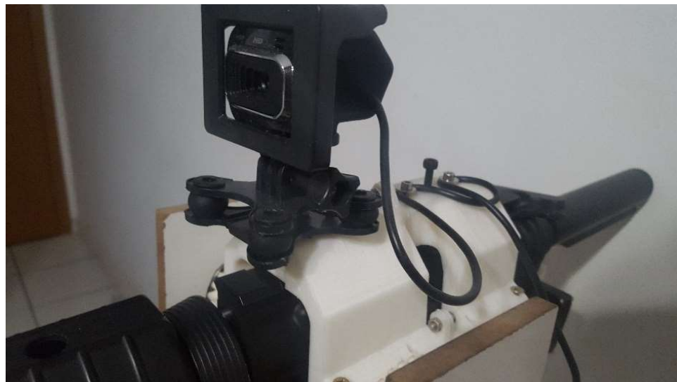
Figura 73: Peça de fixação superior da arma e fixação da câmera.
