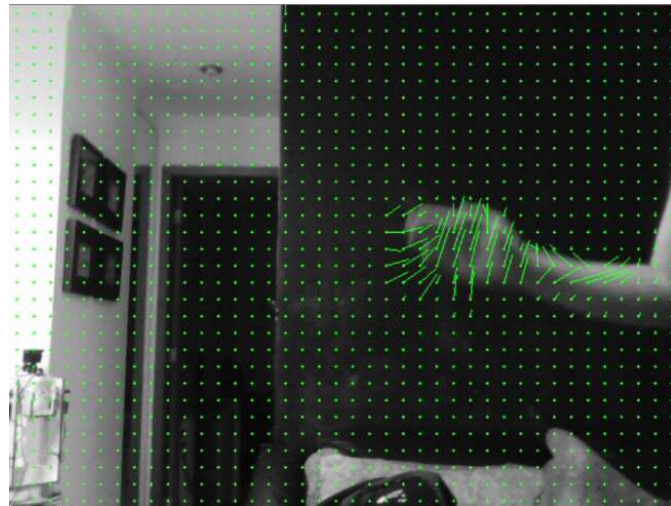
Figura 13: Campo vetorial de optical flow criado com tutorial de Optical Flow da documentação do OpenCV
