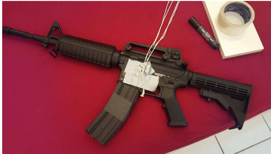
Figura 32: Arma fixada pelo centro de massa
