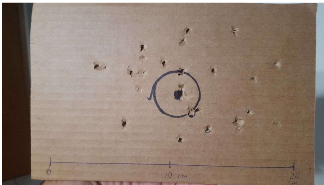
Figura 92: Dispersão de disparos em teste de precisão estática.
