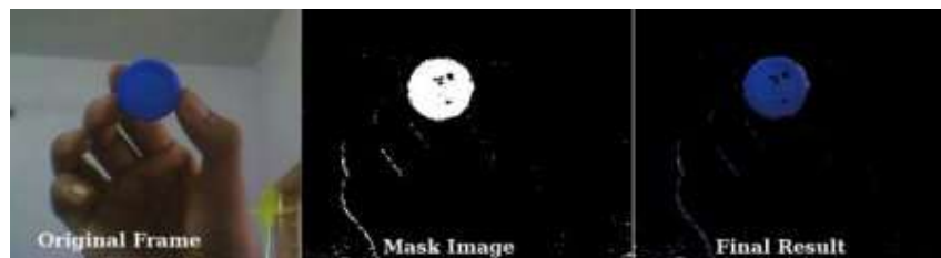
Figura 18: Demonstração de rastreamento por cor [24]
