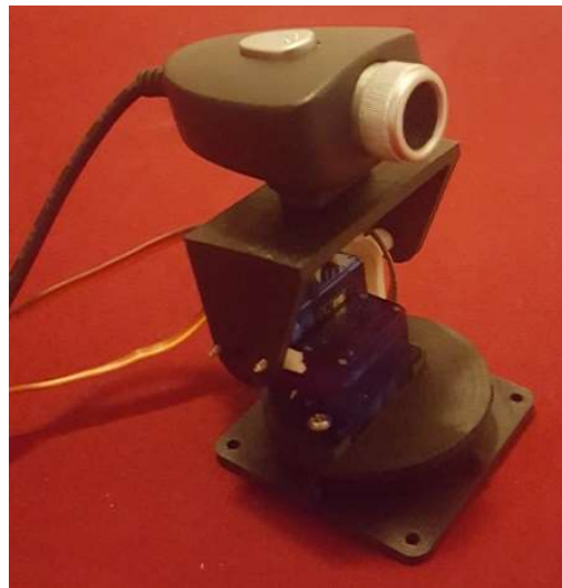
Figura 78: Mecanismo pan-tilt auxiliar prototipado
