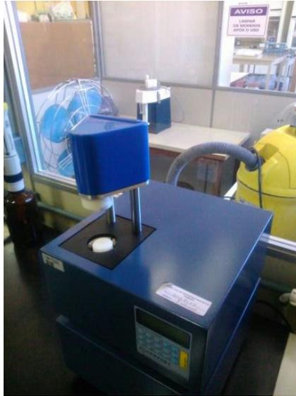
Figura 2.5: Equipamento utilizado para obtenção de medidas de perfil viscoamilográfico.
