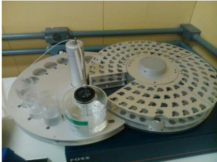
Figura 2.1: Instrumento utilizado para medição da variável TAAFIA (teor de amilose aparente do arroz).
