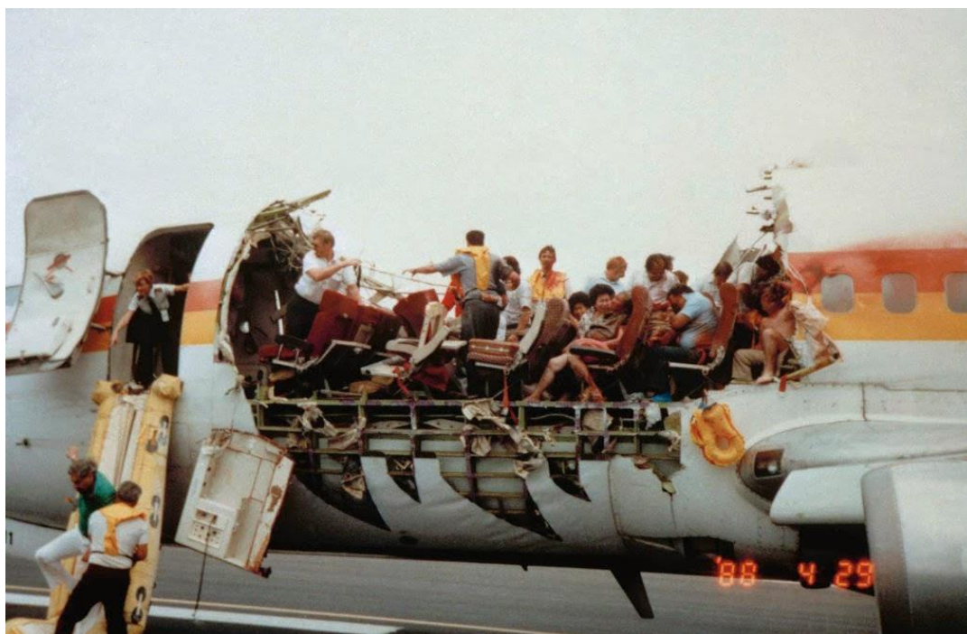
Figura 1 - Aeronave Boeing 737 da companhia aérea Aloha Airlines operou pouso de emergência após colapso da estrutura por corrosão e fadiga (Safe-Skies, Aloha Airlines Files).
