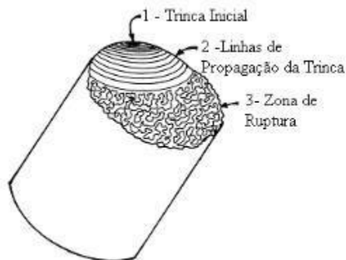
Figura 20 - Características gerais da fratura por fadiga (ASM Handbook Vol 11, 2002).
