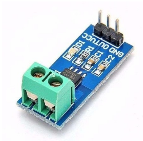
Figura 7 – Sensor de corrente de efeito Hall ACS712 para aplicações que utilizam até 20A. Este módulo possui um conector onde é fornecida a corrente de entrada, dois pinos dedicados à alimentação (VCC e GND) e um pino de saída (OUT).
