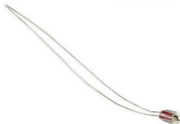
Figura 9 – Sensor de temperatura NTC 3950 de 100kΩ. Possui estabilidade de 1%, ou seja, garante que a variação das características de resistência em relação à temperatura, ao decorrer do tempo, não ultrapassará 0,1°C. Além disso, este termistor pode identificar uma faixa de temperatura que vai -40°C a 300°C.
