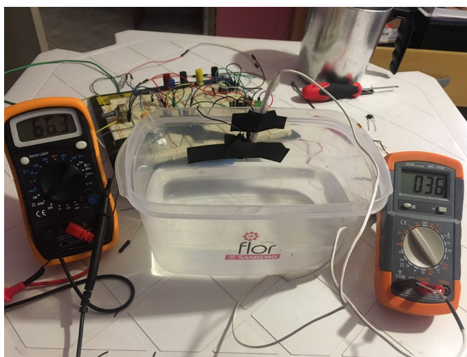
Figura 10 – Experimento realizado a fim de relacionar a mudança de temperatura à sua respectiva resistência, e assim adquirir uma curva que expressa o comportamento entre essas duas variáveis.
