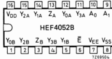
Figura 12 – Diagrama dos pinos do multiplexador analógico de quatro canais HEF4052B, onde os pinos 1, 2, 4 e 5 se referem às entradas de leitura do sensor de corrente e dos sensores de temperatura, respectivamente, enquanto o pino 3 se refere à saída conectada ao PIC16F628A.
