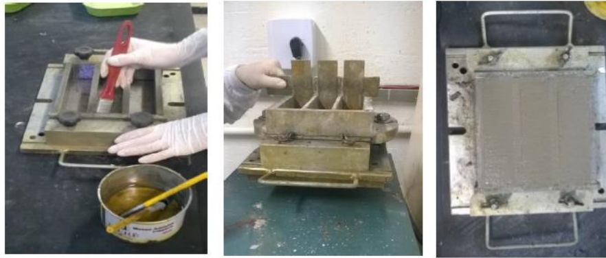
Figura 18: Produção dos corpos de prova. Fonte: Dias (2017) Preparação dos moldes (à esquerda); nivelamento das camadas (centro) e moldes preenchidos (à direita)
