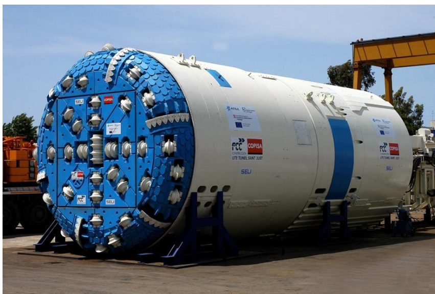
Figura 9: Tuneladora Double Shield
