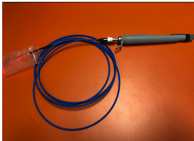
Figura 20 – O Laser está passando livremente por dentro da fibra óptica saindo na extremidade.
