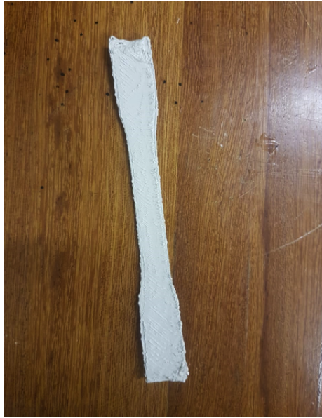
Figura 50 – Corpo de prova apresentando arqueamento e deformidade de camadas
