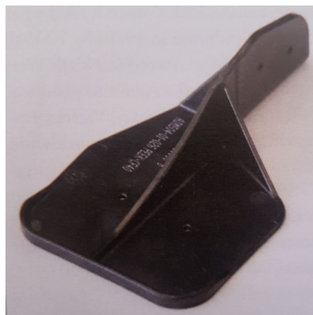
Figura 14 – Suporte em Airbus A350, componente de estrutura primaria desenvolvido pela empresa Victrex.
