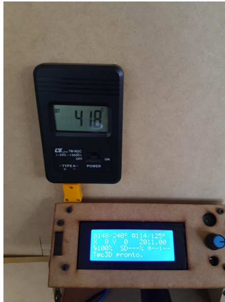
Figura 46 – Bico de impressão chegando à 418 °C
