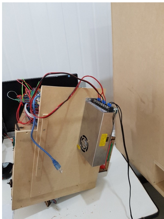
Figura 38 – Realojamento da fonte da impressora
