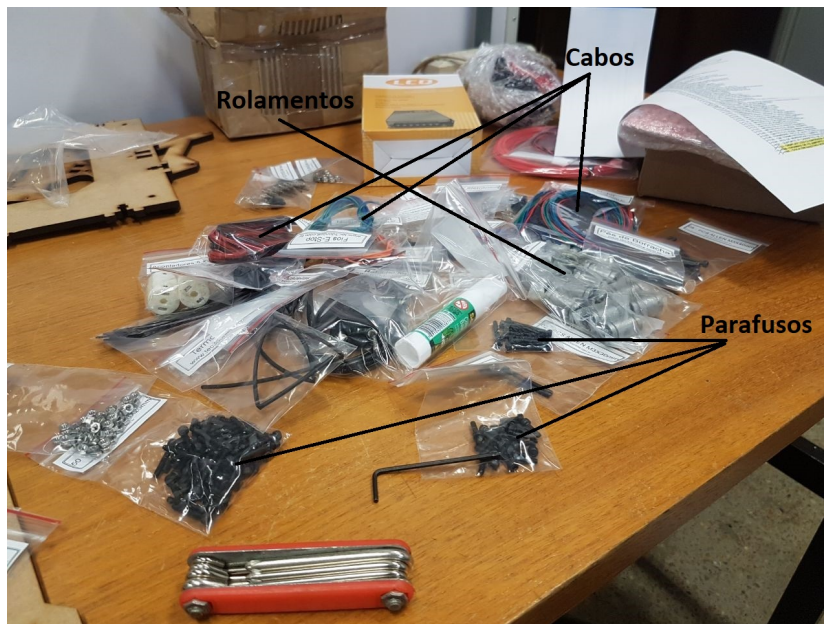
Figura 17 – Reconhecimento dos componentes necessários
