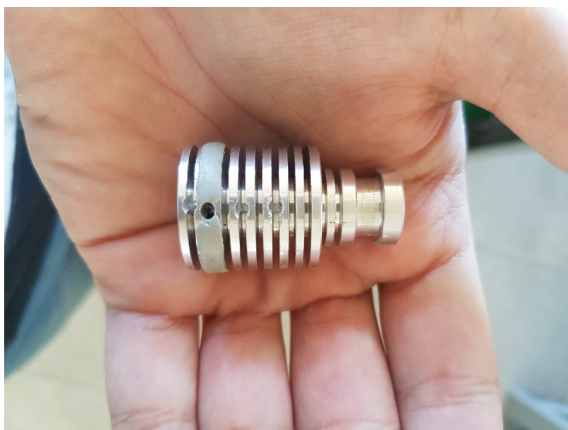
Figura 43 – Dissipador recebe furos para alojar termistor
