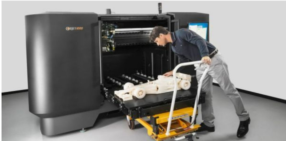
Figura 3 – A impressora 3D Objet1000 é capaz de imprimir em escala real. (OBJECT, 2016)
