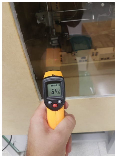
Figura 47 – Parede do ambiente de impressão à 64 °C
