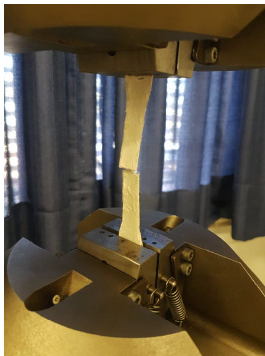
Figura 60 – Arqueamento do corpo de prova de PEEK após a ruptura
