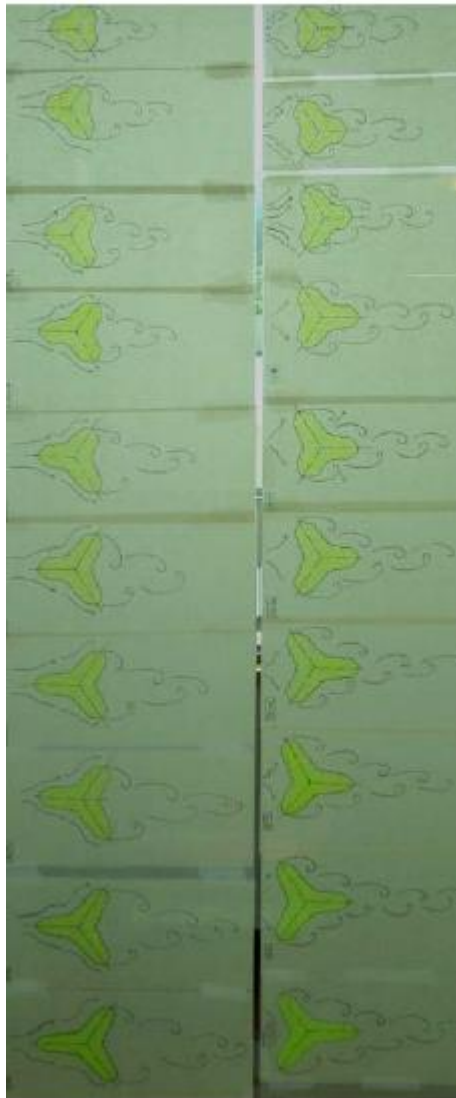
Figura 11 – Formação do desprendimento de Vórtices – cópia do projeto original (Fonte: Abdelrazaq, 2011).
