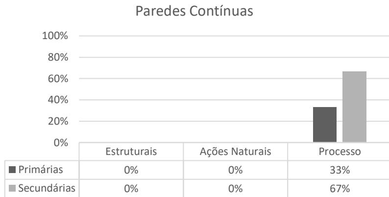
Figura 4.18 – Causas de descolamentos cerâmicos em regiões de paredes contínuas
