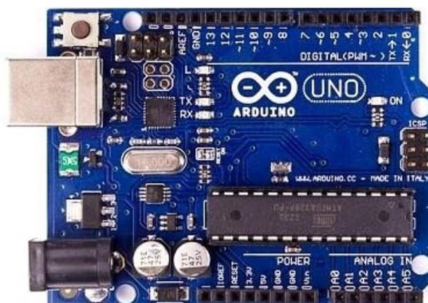
Figura 6 – Placa Arduino UNO (ARDUINO, 2016).
