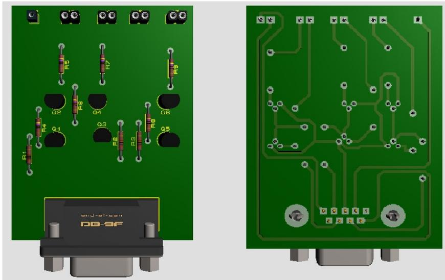
Figura 13: Simulação da placa de chaveamento e acionamento dos LED's em 3D.
