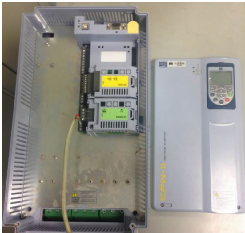
Figura 21 – Inversor de Frequência da Bancada Eólica (SILVEIRA, 2016)
