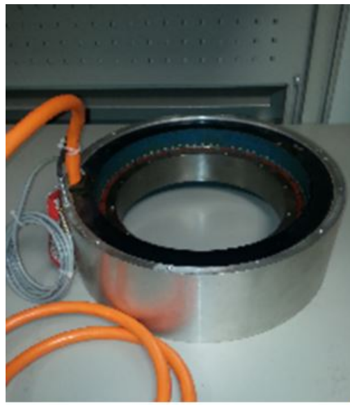
Figura 22 – Gerador PMSG da Bancada Eólica (SILVEIRA, 2016)
