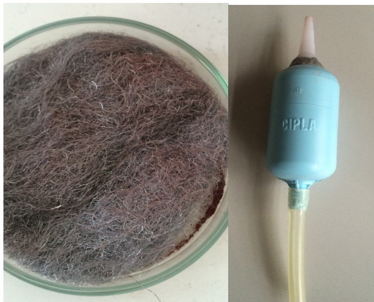
Figura 12. Nanofiltro com esponja de aço.
