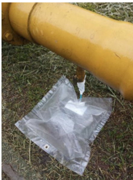
Figura 13. Coleta do biogás da caesb.
