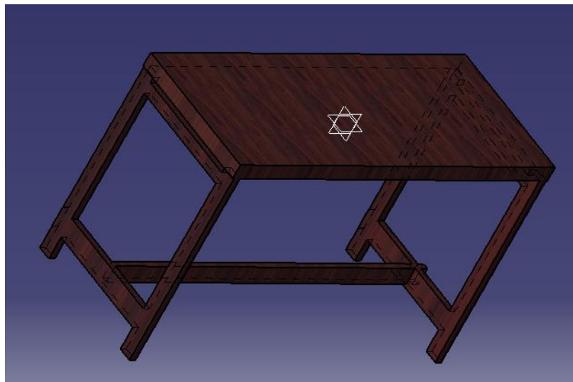
Figura 12-Mesa utilizada pra comportar o ventilador e compressor desenhada no CATIA V5, fonte: autoria própria
