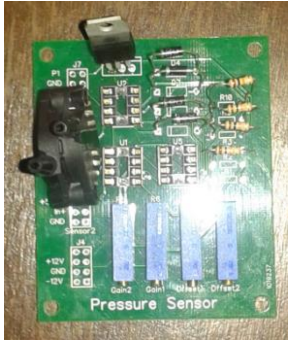
Figura 22-Circuito ceifador pra o sensor de pressão com os componentes soldados, fonte: autoria própria
