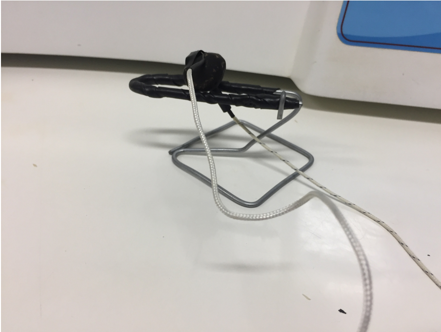
Figura 29: Termopares posicionados no interior e na superfície da macaúba
