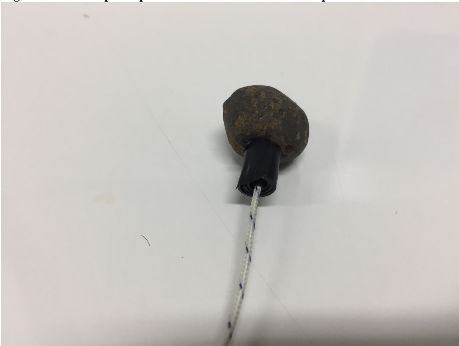
Figura 30: Termopar posicionado no centro do endocarpo da macaúba
