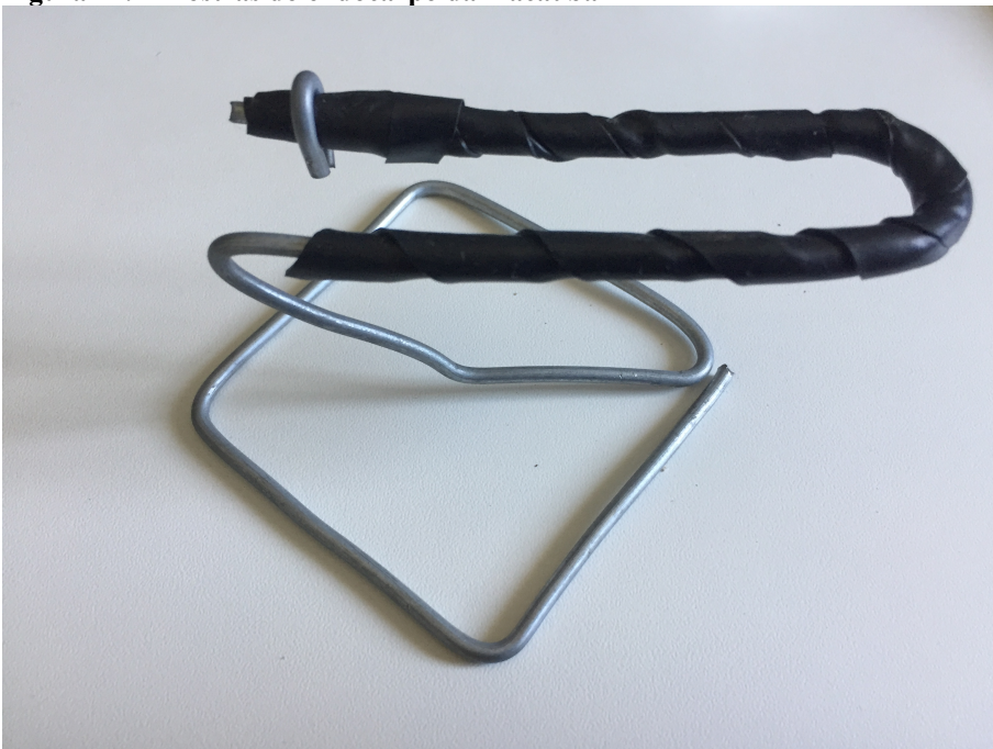
Figura 28: Suporte metálico envolto de fita isolante térmica
