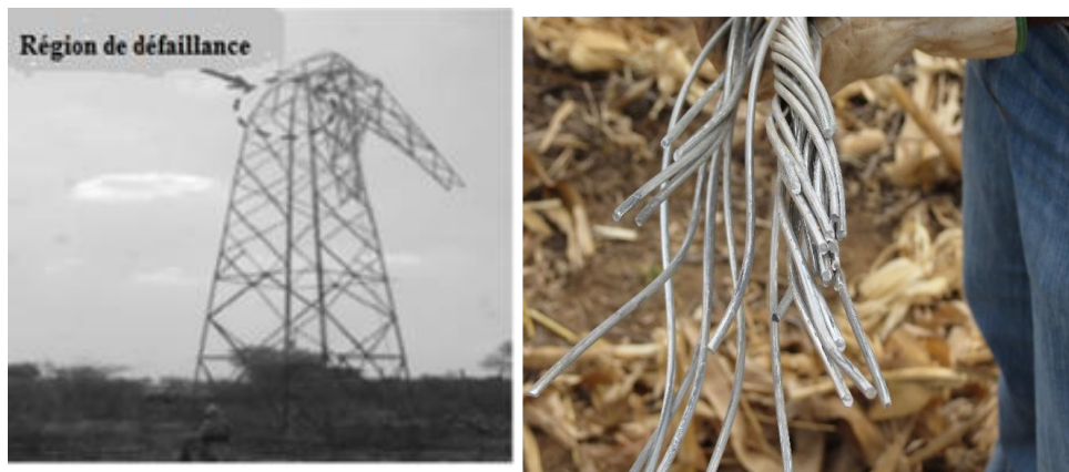
Figure 1.2: (a) Tour de 110 kV cassée dû à la rupture du conducteur (IEEE PES POWER AFRICA, 2012)
