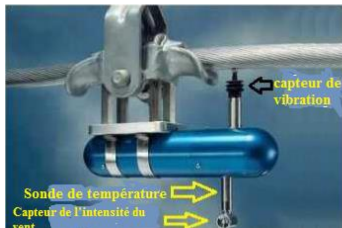
Figure 2. 8: Vibromètre avec le capteur de la temperature et de la vitesse du vent. (CIGRÉ, 2006)
