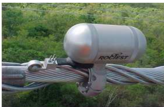
Figure 2. 11: L'illustration du vibromètre PAVICA em campo (EPRI, 2005)
