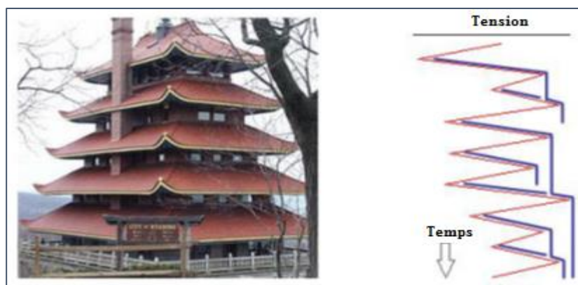
Figure 2. 19: L'analogie entre la méthode Rainflow et le toit Pagoda
