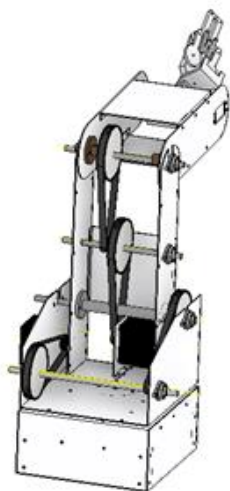
Figura 7.1. Desenho do robô em CAD com o sistema de transmissão por polias
