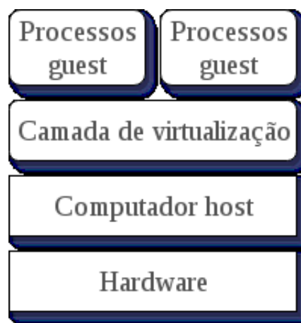
Figura 3 – Virtualização baseada em containers
