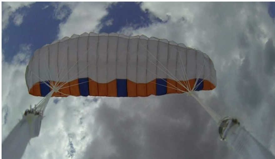
Figura 10 – Paraquedas do tipo parapente usado na missão do LAICAnSat-1 (NEHME et al., 2014).
