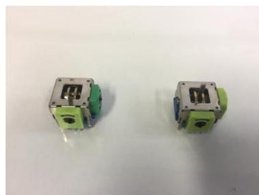
Figura 28 - Potenciômetros analógicos originais
