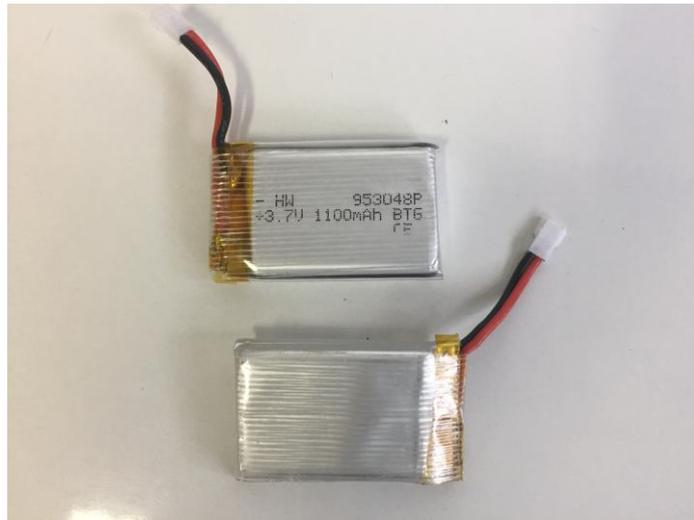
**Figura 17 - 2 baterias de 1100 mAh**
