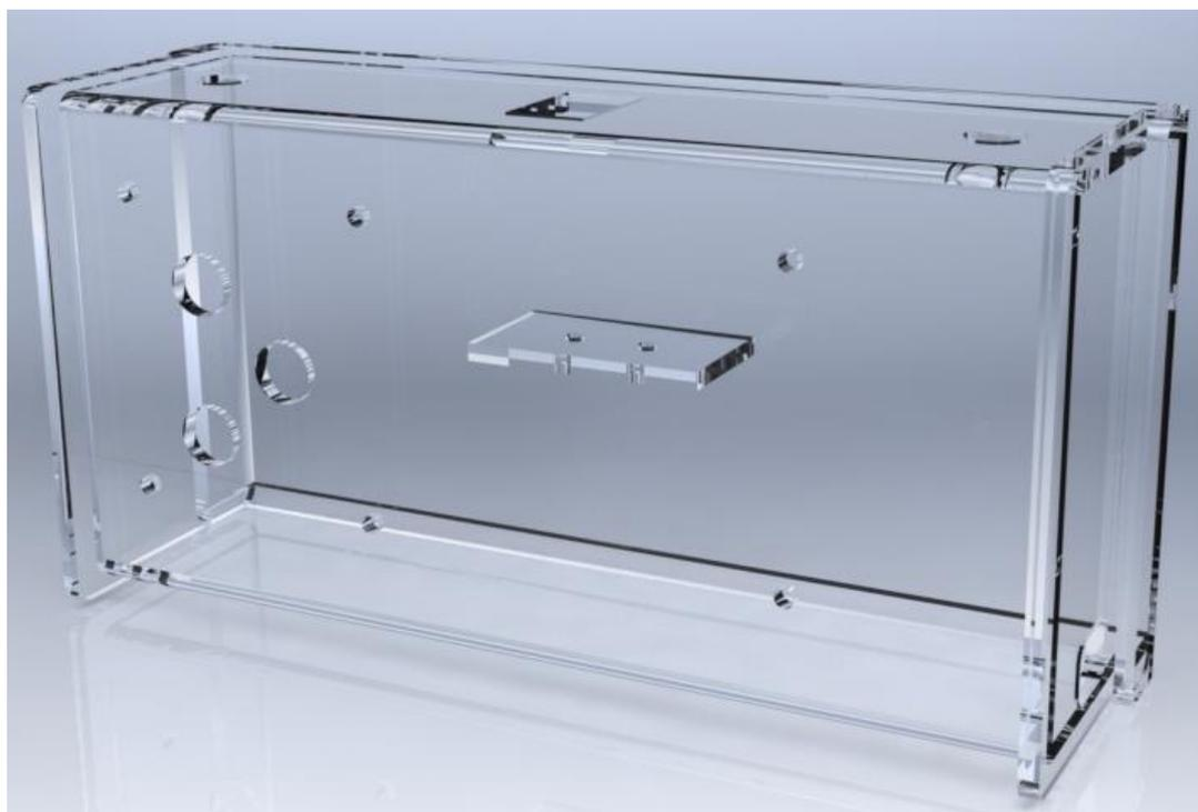
Figura 58 – Modelamento 3D da estrutura de acrílico projetada.
