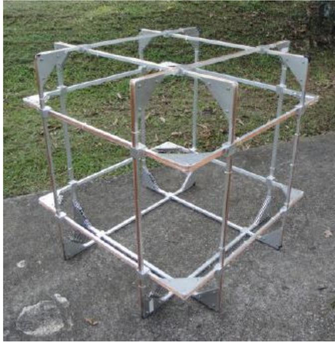
Figura 2.14: Gaiola de Helmholtz do Laboratório de Simulação da Divisão de Mecânica Espacial e Controle do INPE. [5]
