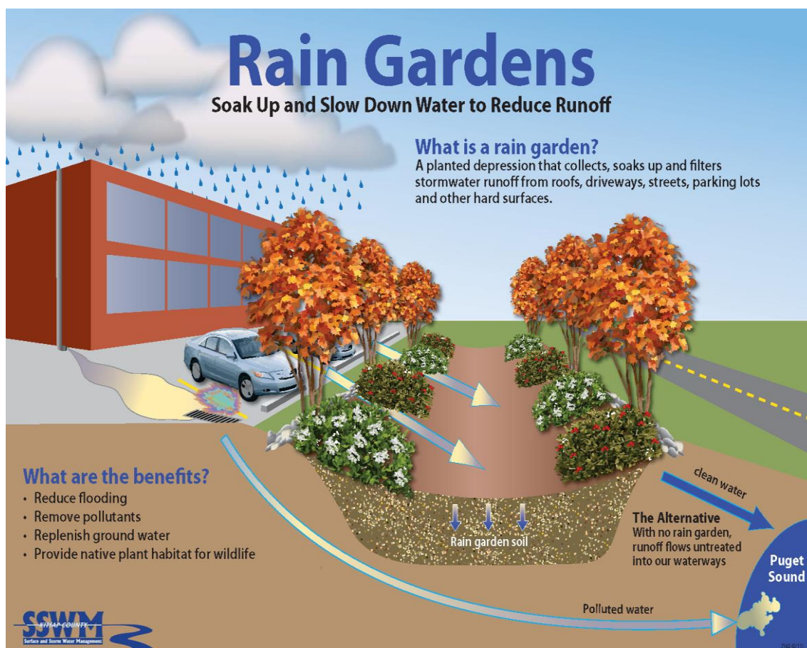
Figura 21. Exemplo de funcionamento dos Jardins de Chuva. Fonte: Google Imagens
