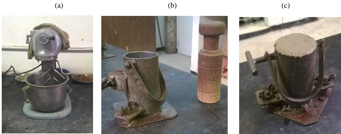
Figura 3.6: Etapas e aparelhagem do preparo e moldagem dos corpos de prova - (a) Misturador mecânico; (b) Molde com o instrumento de referência de camadas; (c) Molde preenchido.
