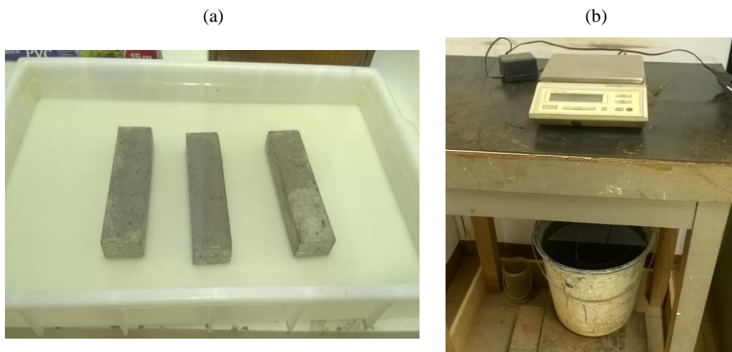
Figura 3.16: Etapas do ensaio absorção por imersão – (a) Amostras submersas; (b) Balança hidrostática
