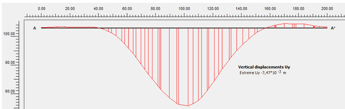
Figura AII.3: Bacia de recalques a 10 m de profundidade na seção 1 do túnel com escavação simultânea
