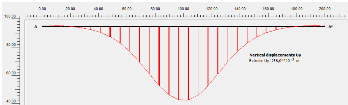
Figura AIII.6: Bacia de recalques a 0 m de profundidade na seção 2 do túnel com escavação em etapas
