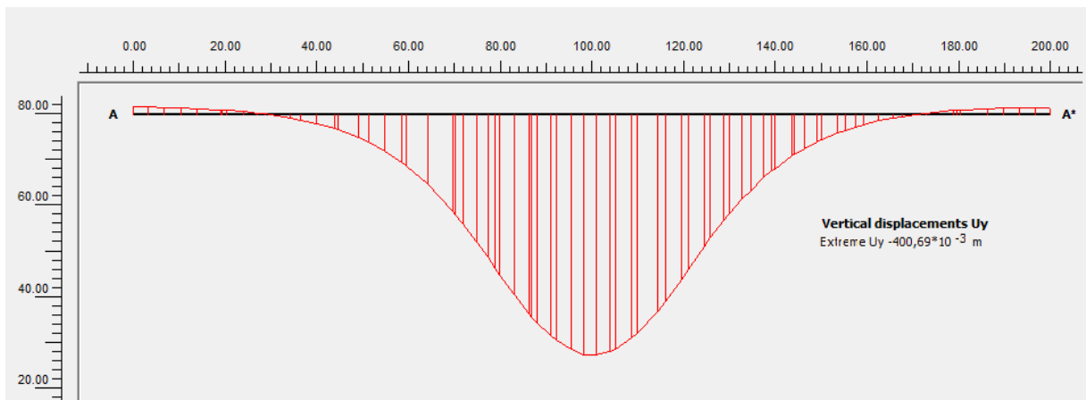
Figura AII.9: Bacia de recalques a 15 m de profundidade na seção 2 do túnel com escavação simultânea
