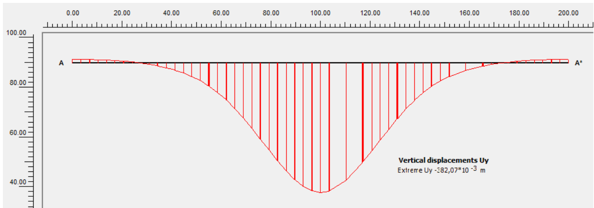
Figura AII.7: Bacia de recalques a 5 m de profundidade na seção 2 do túnel com escavação simultânea
