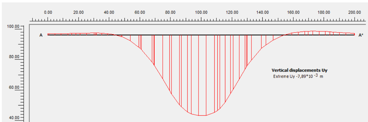
Figura AIII.5: Bacia de recalques a 20 m de profundidade na seção 1 do túnel com escavação em etapas
