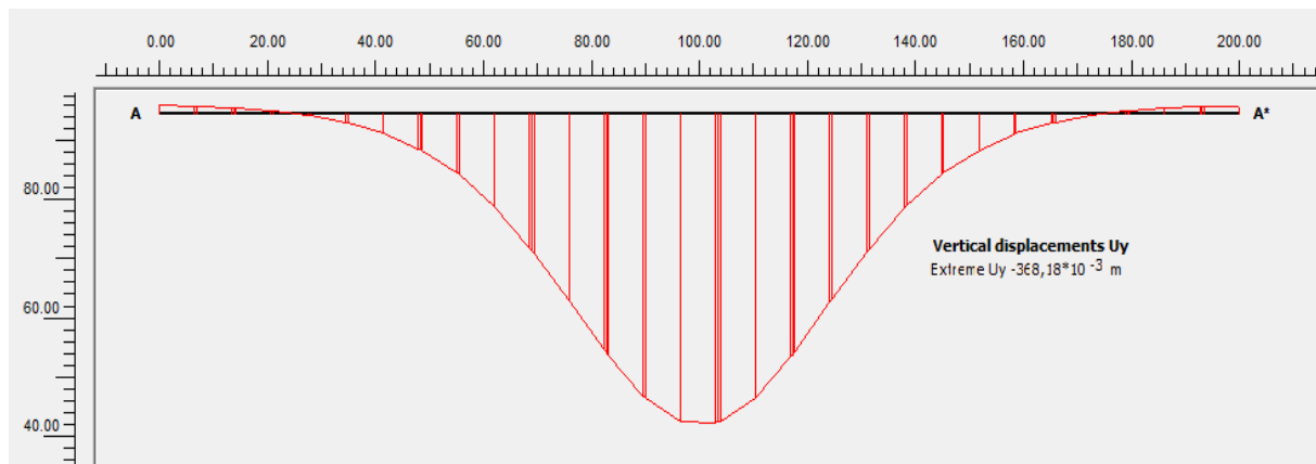
Figura 6.16: Bacia de recalques a 0 m de profundidade na seção 2 do túnel com escavação simultânea
