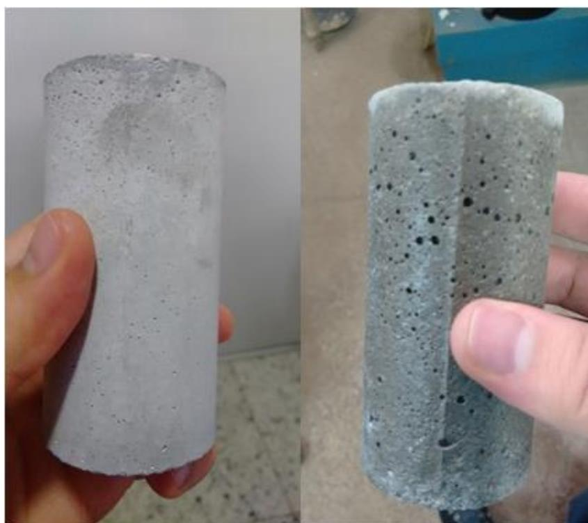
Figura 4-23: Corpos de prova endurecidos – traços 0,5%NS (à esquerda) trazendo pequenos poros e 1,5%NS (à direita) mostrando os grandes poros na argamassa endurecida.
