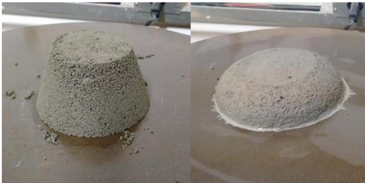
Figura 4-20: Argamassas logo após o ensaio de espalhamento. À esquerda, traço REF, à direita traço SA-1,0%NS.
