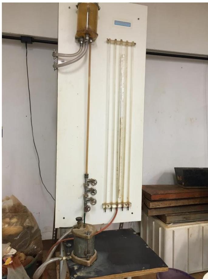
Figura 4.5 – Ensaio de condutividade hidráulica em permeâmetro de parede rígida com carga variável
