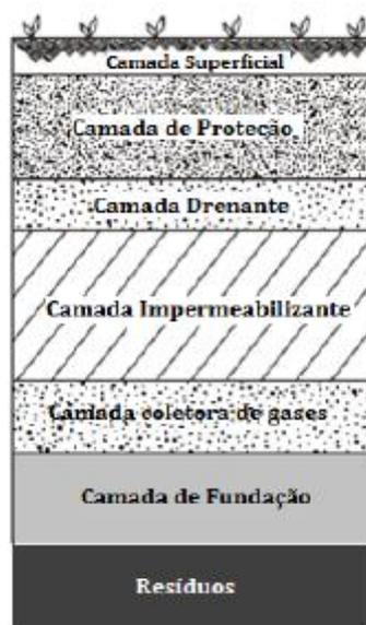
Figura 2.7 - Componentes típicos de uma camada de cobertura (US.EPA, 2004).
