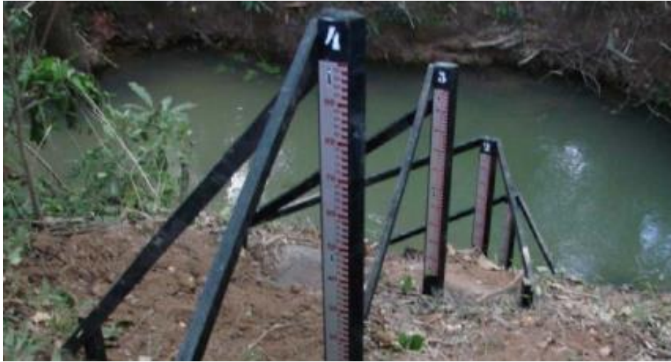
Figura 5. Réguas linimétricas estação fluviométrica convencional. Fonte: INEA 2016
