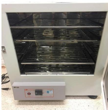
**Figura 3:** Estufa utilizada para secagem das sementes de *Handroanthus impetiginosus* submetidas a temperatura de  $105^{\circ}\text{C}$ .
