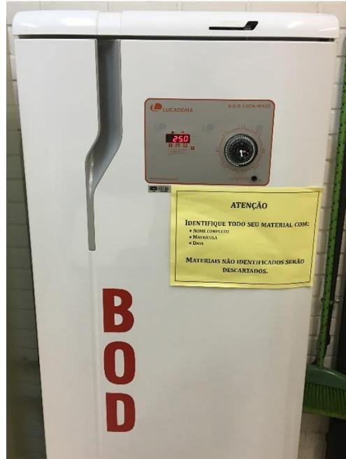
**Figura 5:** Câmara de germinação tipo B.O.D. onde foi realizado o teste de germinação das sementes de *Handroanthus impetiginosus* a temperatura de 25°C.
