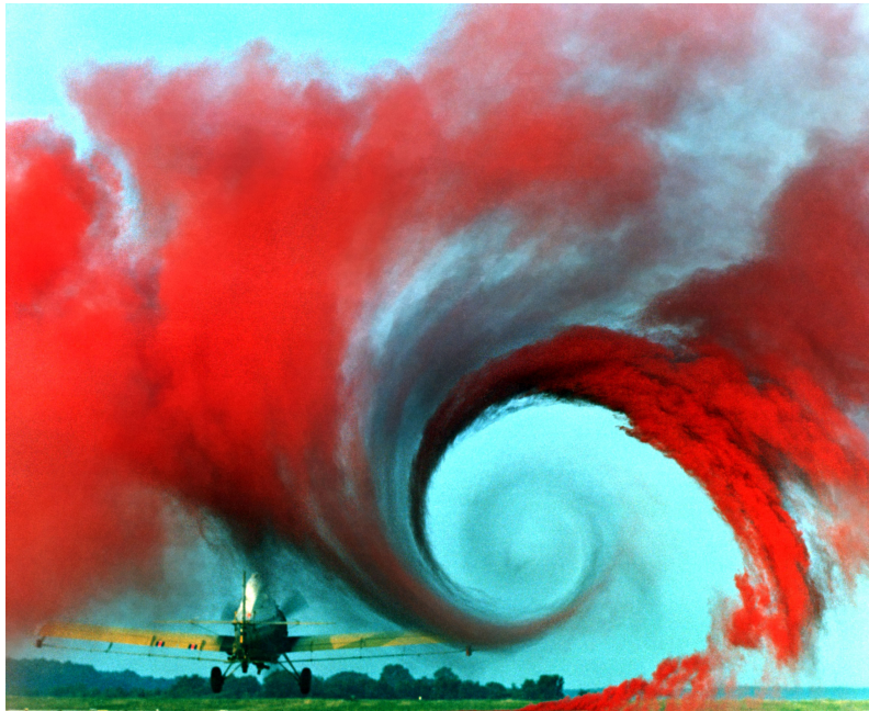
Figura 1 – Vórtice de ponta de asa gerado pelo efeito do campo de pressão em uma asa finita. (NASA-LARC, 1990)
