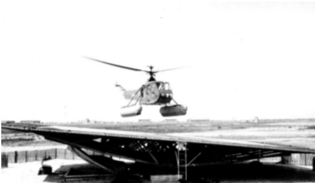
Figura 1.5: *Teste da influência da oscilação do solo em helicópteros pairando sobre embarcações* (Fonte: [Beard 1996])
