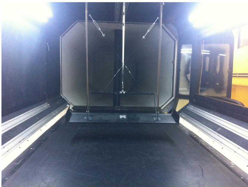
Figura 4.46: Túnel de Vento Utilizado no Experimento
