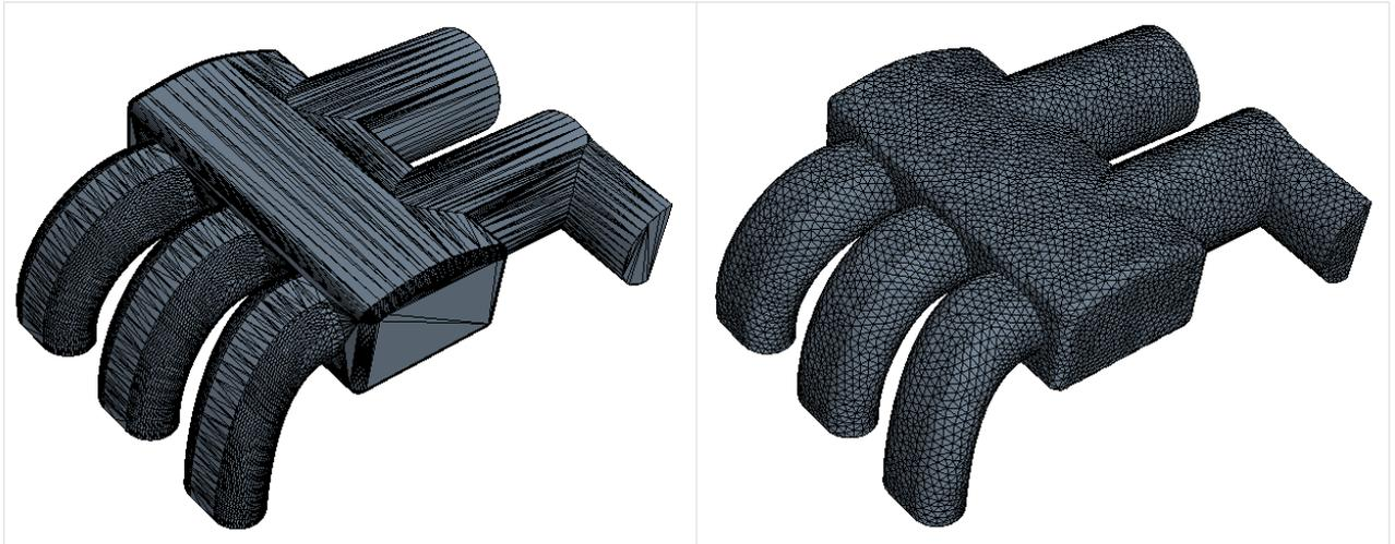
Figura 3.6: *Exemplo de malha superficial antes e depois da aplicação de surface remesher (Fonte: StarCCM+ User Guide)*
