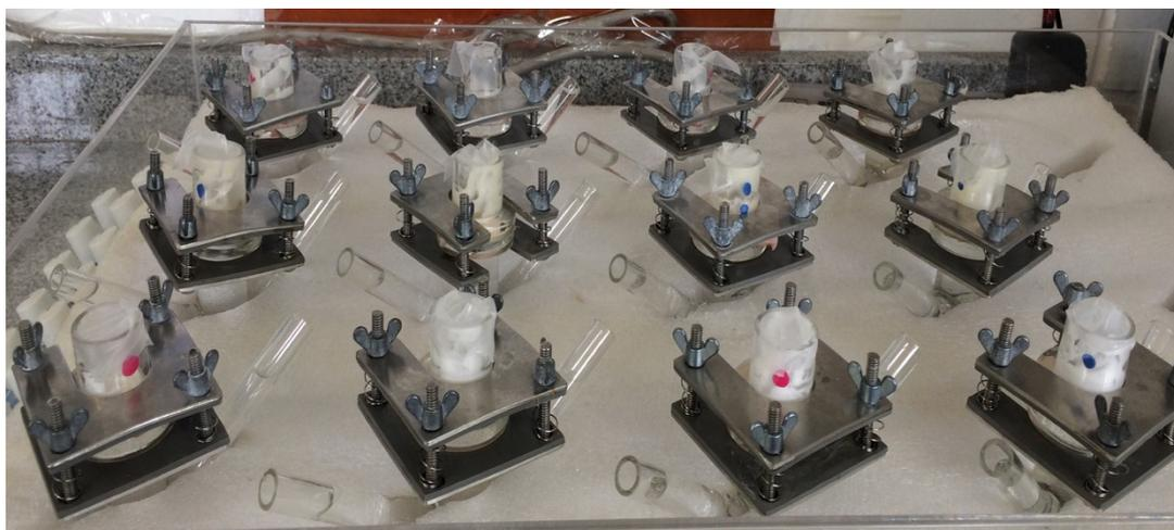
**FIGURA 6.** Formulações dispostas em células de difusão de Franz. Cada linha horizontal indica uma formulação. Experimento em quadruplicata.
