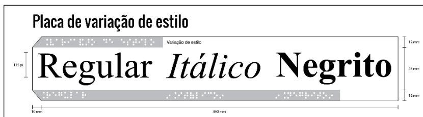
Figura 27. Desenho técnico da placa de variação de estilo (fonte: a autora)
