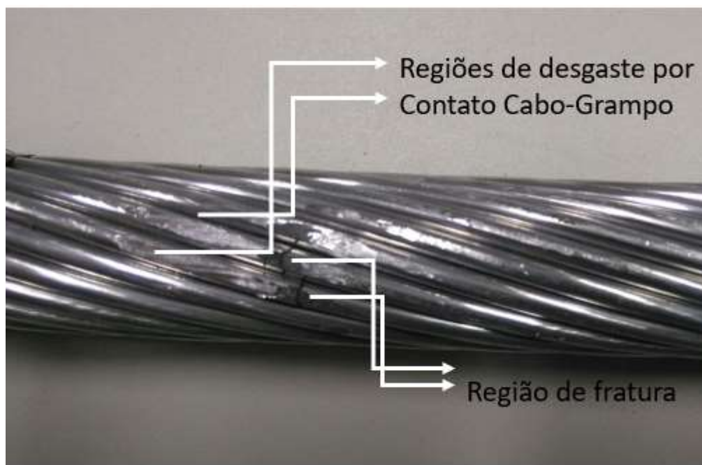
Figura 1-1 - Regiões de fratura e desgaste (Cabo ACAR 750 mcm da Nexans, 20% eds yb 0.76 mm).
