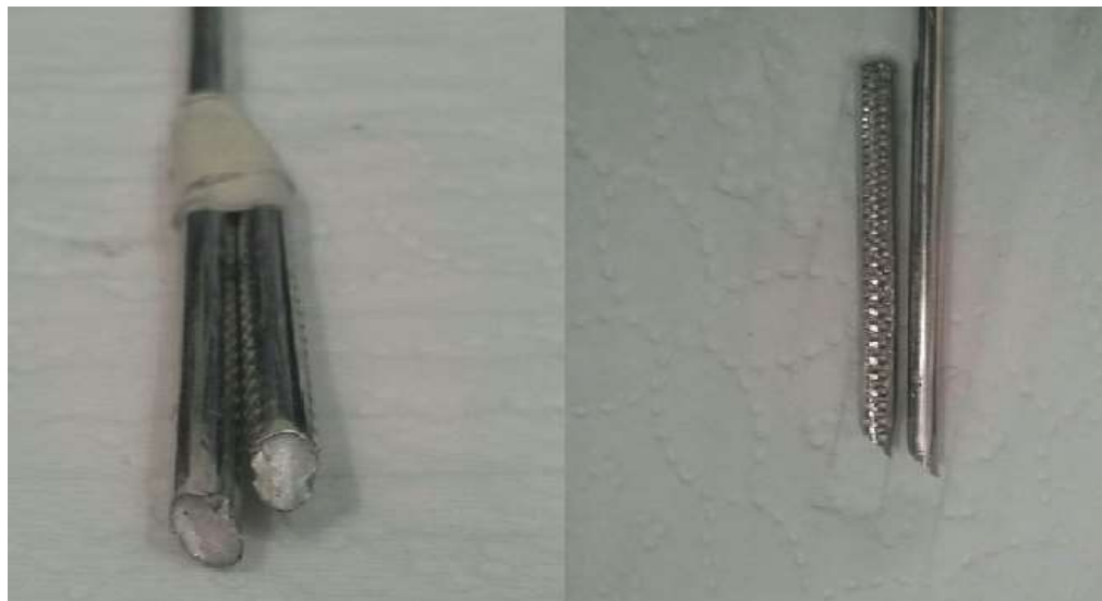
Figura 4-5 -Modo de falha da liga AA 6201 T81 após ensaio de tração.
