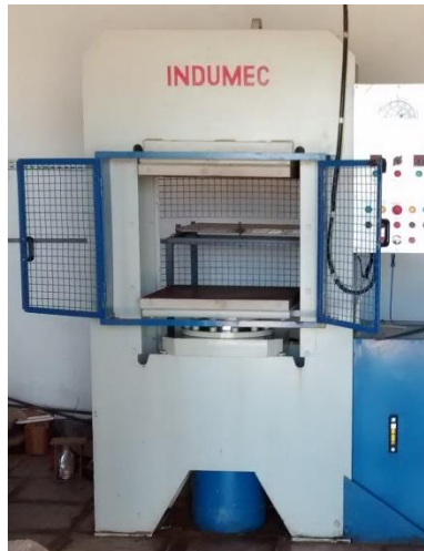
Figura 2. Prensa hidráulica usada nos tratamentos termomecânicos.
