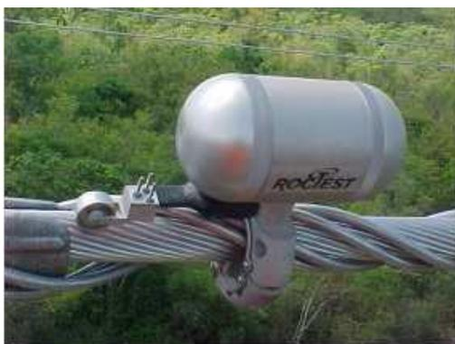
Figura 3.5 - Vibrógrafo do tipo Pavica montado em uma linha de transmissão (EPRI, 1979)
