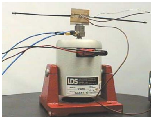
Figura 1.4 - Foto do absorvedor dinâmico de vibrações desenvolvido [8]
