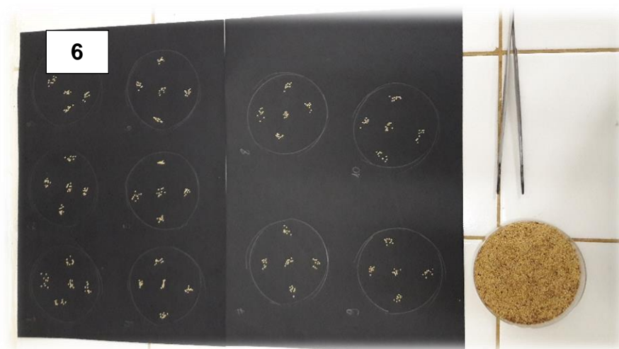
Figura 6. Cartolina preta e pinça longa, usadas para a contagem dos grãos de quinoa e amaranto.
