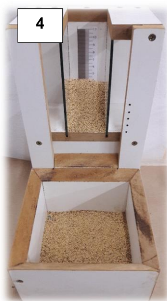
Figura 4. Equipamento utilizado para encontrar o ângulo de repouso.
