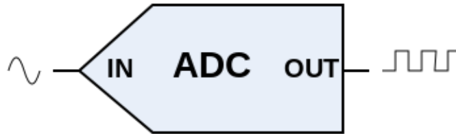
Figura 2.9: Representação de um conversor A/D.
