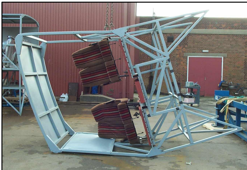
Figura 13. Seção da estrutura de ônibus deformada após impacto (Belingardi et al., 2013)
