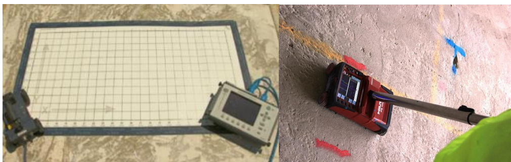
Figura 2.6 – Exemplos de sistemas GPR desenvolvidos para o uso no concreto armado (PARKER, 2010 e www.cnplus.com.uk ).
