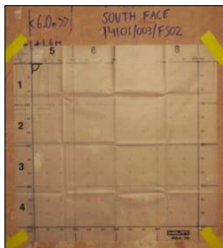
Figura 3.4 – Grelha referenciada anexada à estrutura (fonte: http://www.rnpassociates.co.uk/surveying/ ).
