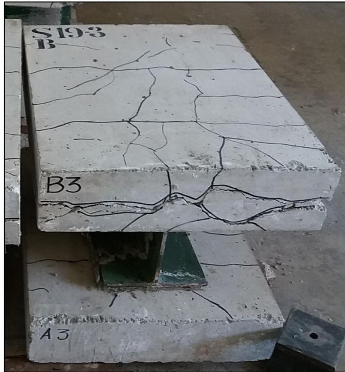
Figura 5.14 – Laje com conectores “stud bolt” submetidas ao ensaio.
