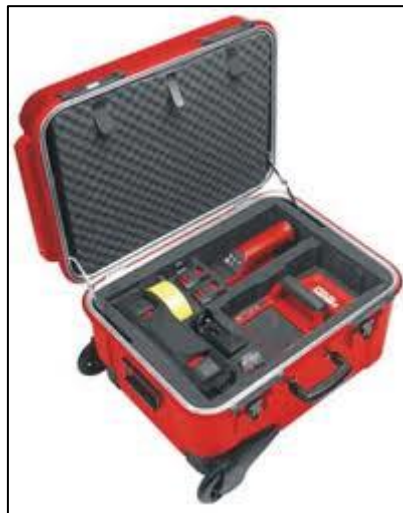
Figura 3.1 – Hilti PS 1000 X-Scan System – Modelo de GPR utilizado. (fonte: www.masterbuilder.co.in ).
