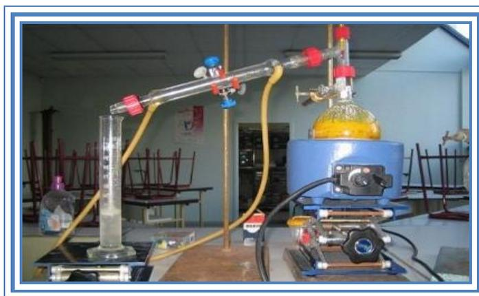
**Figura 2:** Aparelho de hidrodestilação
