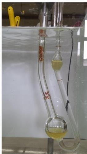
**Figura 11: Viscosímetro de 150 com óleo comercial de copaíba.**
