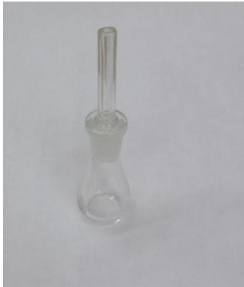
**Figura 10: Picnômetro utilizado para medir densidade de líquidos.**
