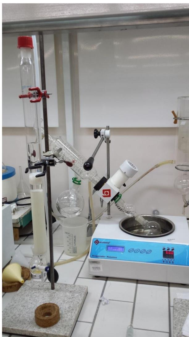
**Figura 13: Coluna cromatográfica e rotoevaporador à vácuo.**
