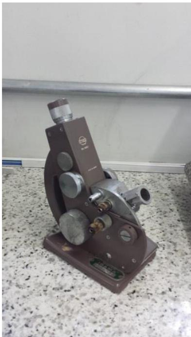
Figura 8: Refratômetro utilizado
