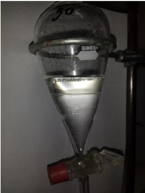
Figura 15: Separação líquido-líquido efetiva do óleo bruto em metanol (parte inferior) e n-hexano (superior).
