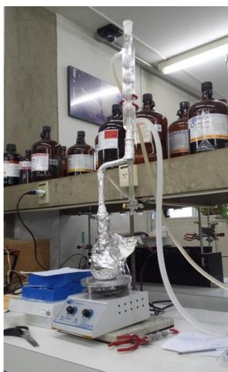
**Figura 12: Esquema montado para hidrodestilação**
