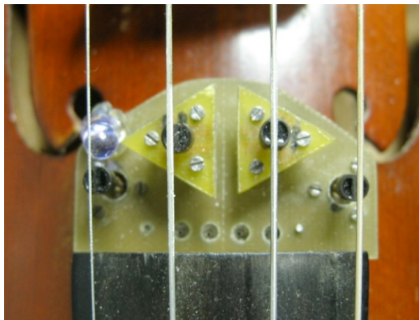
Figura 1.2 – Dispositivo ótico de captação eletroacústica de um violino (projeto do IRCAM)
