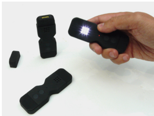
Figura 1.3 – O módulo sem fio de controle gestual (projeto do IRCAM)
