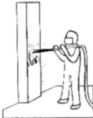
Figura 2.4- Tratamento da superfície de concreto com jateamento de areia (CASTRO, 2014)
