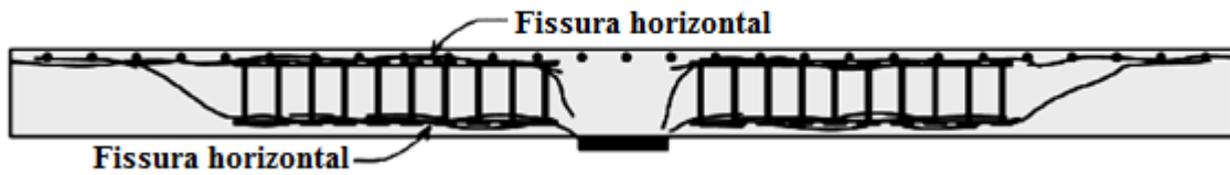
Figura 36 - Modo de fissura por descolamento
