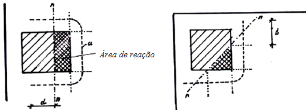
Figura 9 – Área de influência de pilar de borda e de canto
