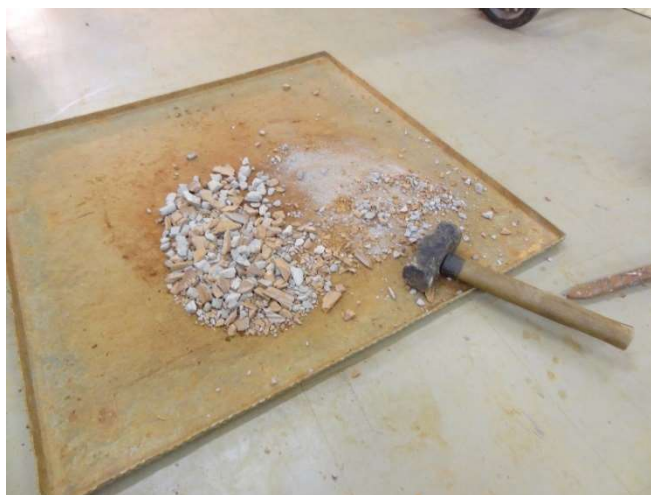
Fig. 3.6: Britagem Manual do RCD
