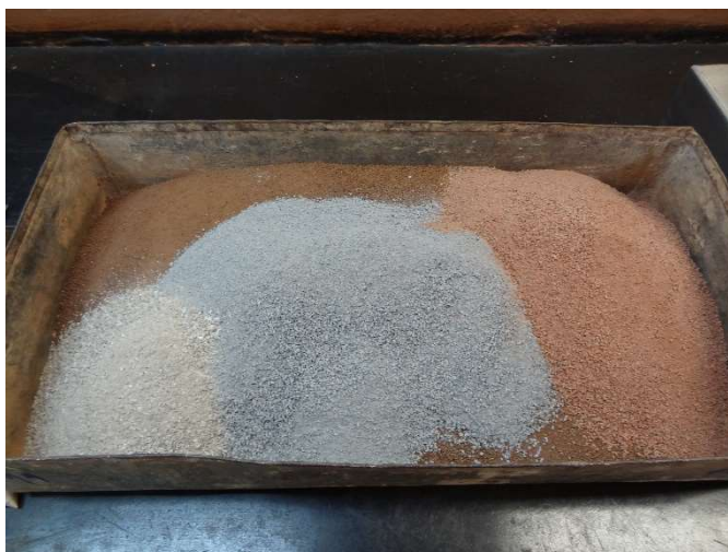
Fig. 2.20: Massa de solo com adição de RCD antes da homogeneização da mistura.
